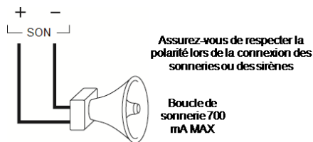
Figure 2-12 Câblage de sonnerie
